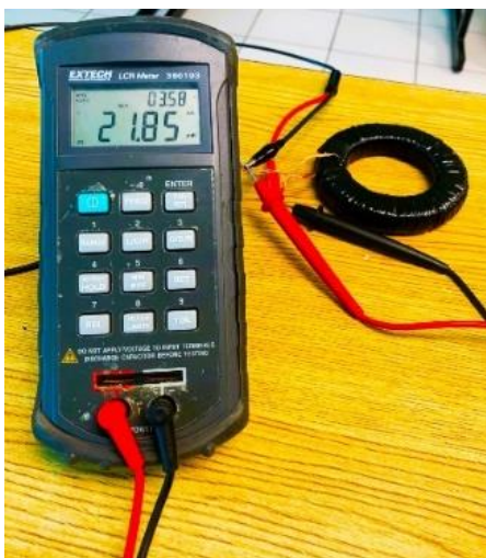
Fig. 8. Inductancia del devanado primario.
