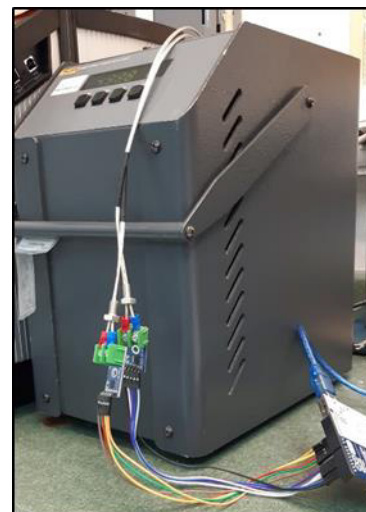
Fig. 11. Los termopares se introducen al horno de calibración FLUKE para verificar su comportamiento en un cambio de temperatura.
